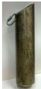
شکل ۱۵- مثالی از نمونه بردار آب کف مخزن و نمونه بردار OBQ/RBO
